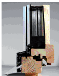
FENETRE BOIS ALUMINIUM BASSE ENERGIE TRIPLE VITRAGE Triple vitrage 4/8/4/8/4 avec gaz krypton épaisseur totale 28 mm coef Uw=1.10 W/m 2 .K
